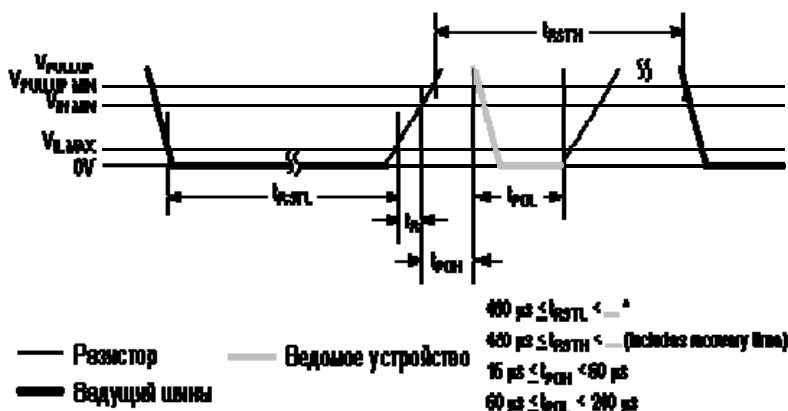
Рис. 4. Импульс сброса и обнаружения присутствия
