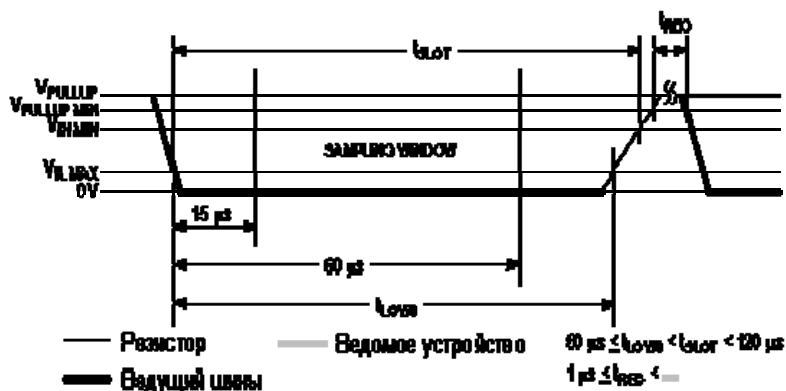
Рис. 2. Временная диаграмма записи логического нуля
