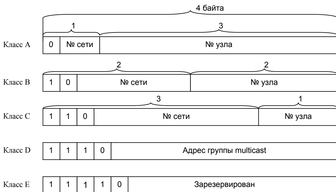
Рисунок 2.6 – Структура IP-адреса
