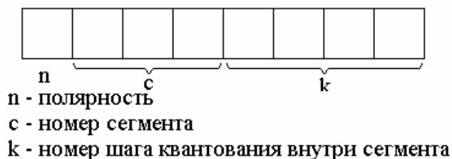
Рисунок 5.3 – Формат восьмиразрядной ИКМ комбинации с компандированием по закону \mu=255
