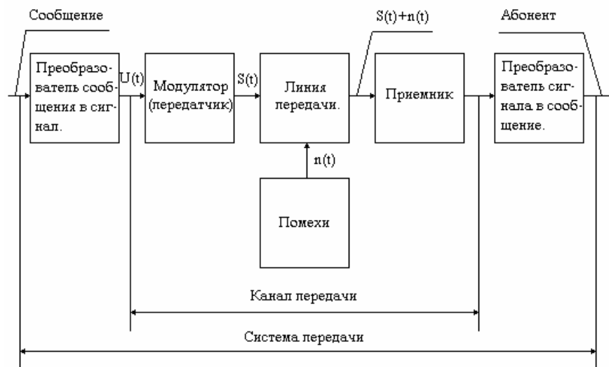
Рисунок 1.1 - Структурная схема системы передачи
