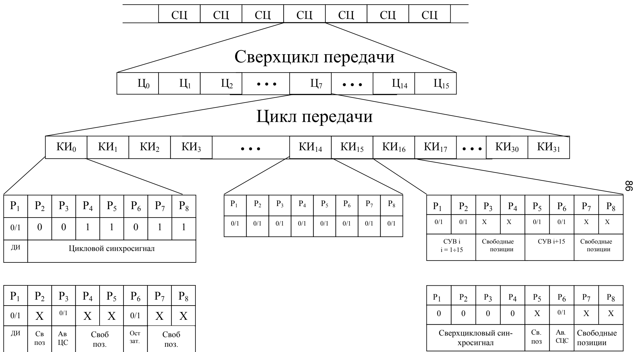
Рисунок 4.5.8 –Временной спектр ИКМ-30
