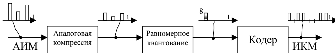
Рисунок 4.2.2 – Принцип аналогового компандирования
