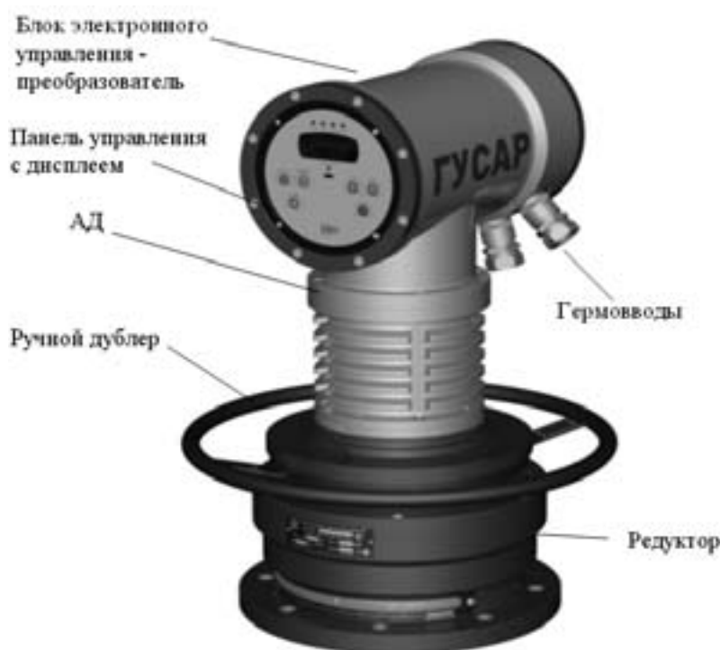
Рис.3.32. Электропривод запорно-регулирующей арматуры «ГУСАР» с блоком электронного управления ESD-VCX
