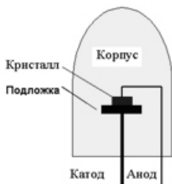
Рис.5.1. Устройство светодиода
