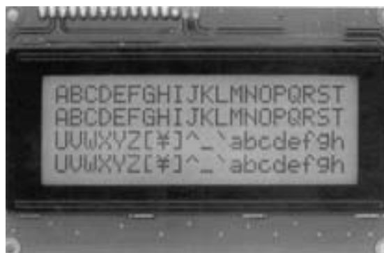
Рис.5.9. Пример знакосинтезирующего индикатора с разрешением 20 символов на 4 строки
