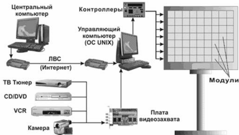
Рис.5.7. Блок-схема системы управления светодиодным экраном
