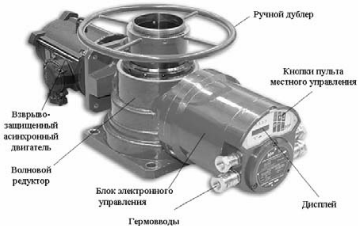
Рис.3.25. Электропривод запорной арматуры (на примере «Elesyb» с блоком электронного управления ESD-VC ЗАО «ЭлеСи», Россия)
